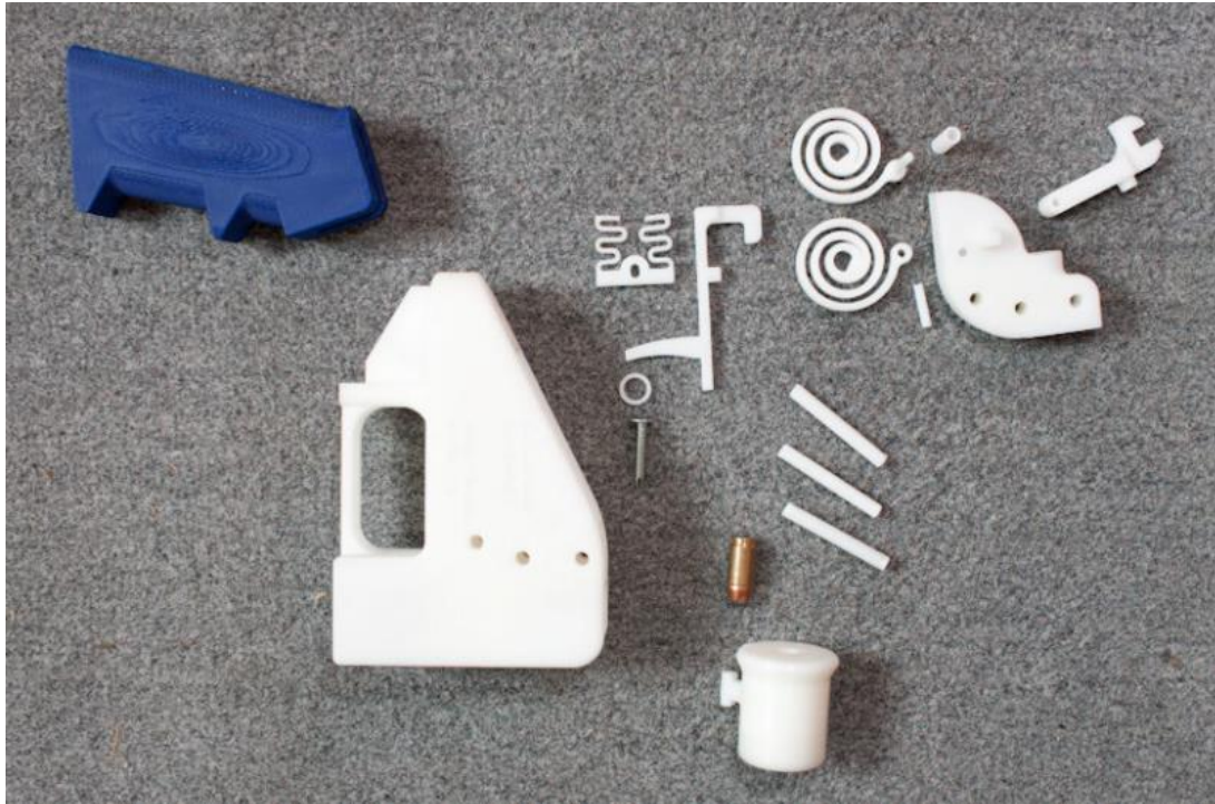
Εικόνα 5: Το πρώτο τρισδιάστατα εκτυπωμένο όπλο με την ονομασία «Απελευθερωτής» (The Liberator) αποσυναρμολογημένο στα δεκαέξι μέρη του, Πηγή: (Greenberg, 2013b).
