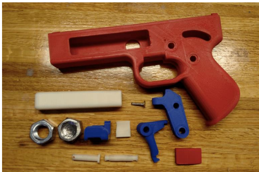
Εικόνα 9: Τα τμήματα του τρισδιάστατα εκτυπωμένου όπλου «Songbird», Πηγή: (PrintedFirearm, 2015)
