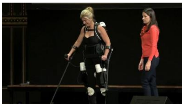
Εικόνα 2: Παράδειγμα «τρειςδιάστατου εκτυπωμένου» εξωσκελετού για ιατρικούς σκοπούς, (Πηγή: Russon, 2014)
