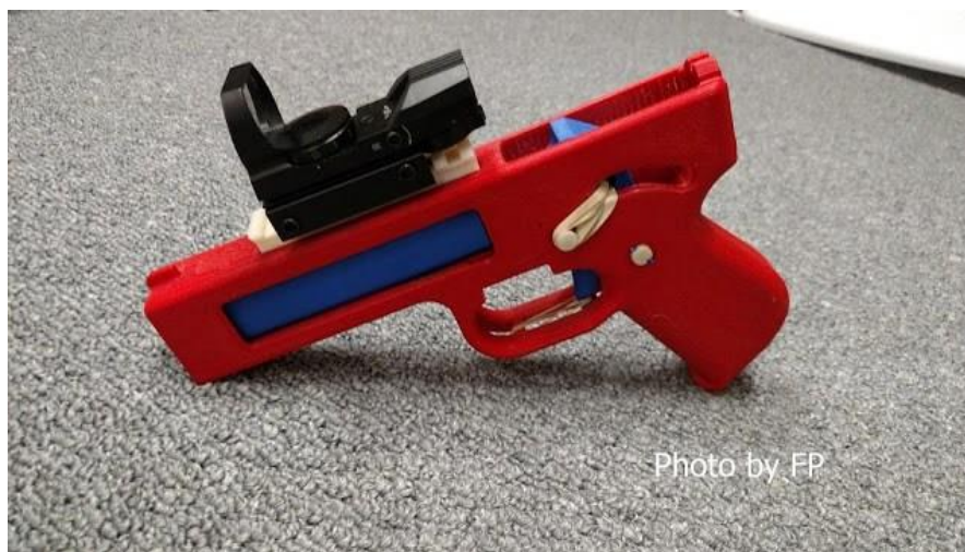
Εικόνα 8: Το τρισδιάστατα εκτυπωμένο πιστόλι «Songbird» με ενσωματωμένη δίοπτρα σκόπευσης, Πηγή: (PrintedFirearm, 2015)
